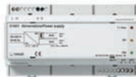
01801 Moduł zasilający, 29 V d.c. 800 mA, 120-230 V~ 50-60 Hz
