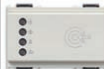
16926.B Czytnik kart transpondero- wych instalowany na zewnątrz pomieszczenia, KNX EIB, 2 wej- ścia, 2 wyjścia, przekaźnik NO 2 A 24 V~ - 3-modułowy
