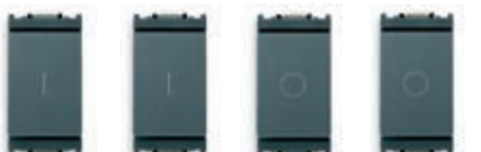
16101 1P NO 16 A, (ON) 16107 1P NO 16 A, (ON), styk pomocniczy NC 16 A 16104 1P NC 16 A, (OFF) 16110 1P NC 16 A, (OFF), styk pomocniczy NO 16 A
